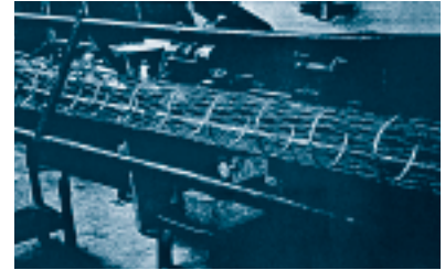
Figura 09. Polígono Funicular de Revolución, materialización de la idea de cuerda rígida y hueca, maqueta.
